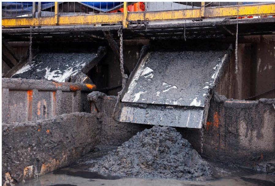
Abb. 11: Separierter Feststoff/Bohrklein wird in einem Cuttingcontainer gesammelt und entsprechend einem genehmigten Entsorgungsplans entsorgt
