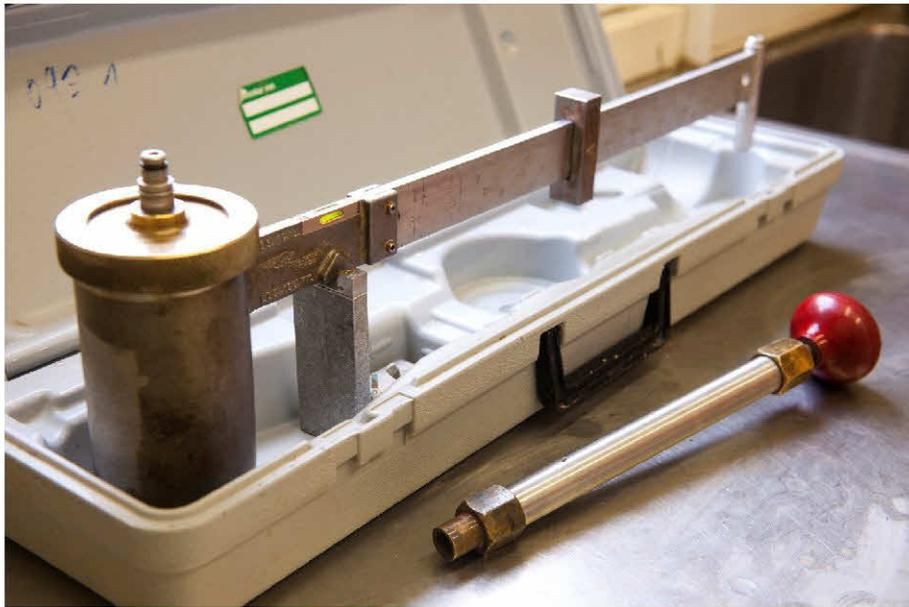
Abb. 12: Spülungsdruckwaage zur Dichtebestimmung der Bohrspülung
