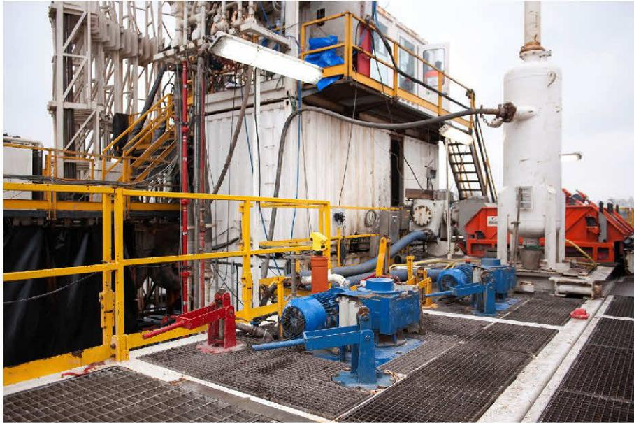
Abb.: 5 Auf der Tankanlage, Rührwerkmotor im Vordergrund, Schüttelsiebe im Hintergrund
