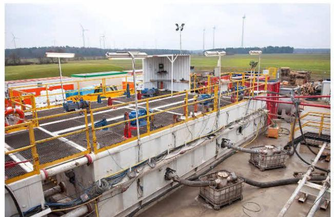
Abb.: 3/4 Typische Tankanlage einer kleineren Tiefbohranlage
