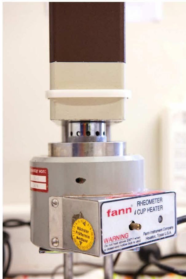
Abb. 13: Fann 35 Viskosimeter zur Bestimmung der Spülungsrheologie
