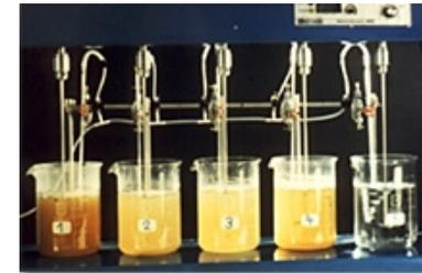
Zahn-Wellens-Test mit Reihenrührgerät.
