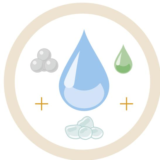
Die Fracking-Flüssigkeit besteht zu etwa 95 bis 99 Prozent aus Wasser und Stützmitteln wie natürlichem Quarzsand oder Keramik Kügelchen. Diese dienen dazu, die künstlich geschaffenen Fließwege offen zu halten. Dem Wasser werden zudem chemische Substanzen, sogenannte Additive, beigelegt, damit der Quarzsand sich nicht mit dem Wasser vermischt, und um Reibung zu mindern.
