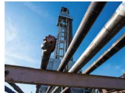
Bild: Um tief zu bohren, bedarf es einiger Meter an Bohrgestänge – und auch der Meißel muss, je nach Bodenbeschaffenheit, ab und an ausgetauscht werden.
