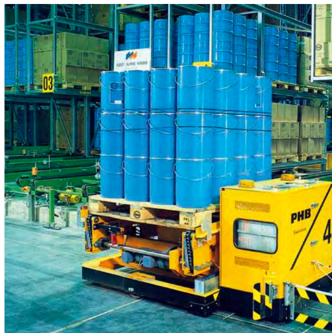
Schmierstoffe lagern in einem computergesteuerten Hochregallager mit Raum für 10.000 Paletten
