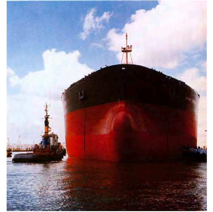
Der von der Esso Tankschiff Reederei entwickelte Wulstbug verringert den Wasserwiderstand und spart Treibstoff
