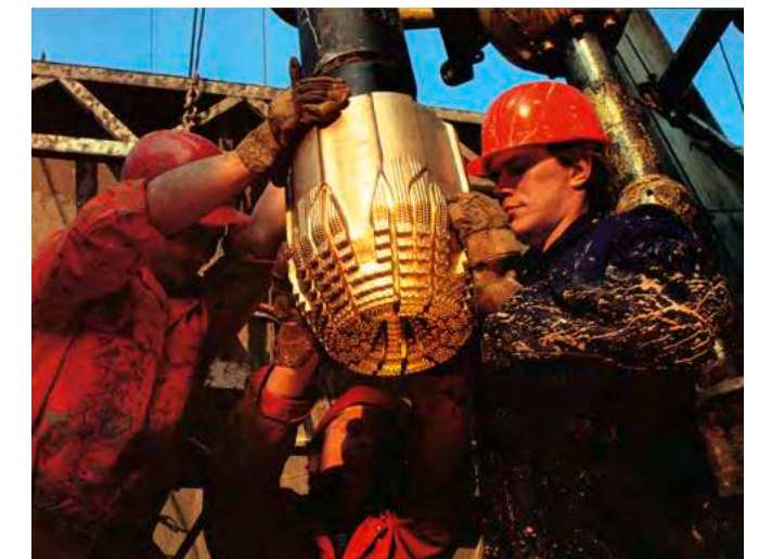
Bohrarbeiter beim Ansetzen eines neuen Bohrmeißels
