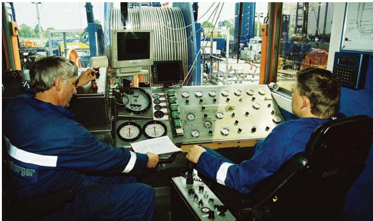
▲ Bei der Coil-Rig-Technologie wird der Bohrstrang auf einer 5 m hohen Trommel „aufgewickelt“
